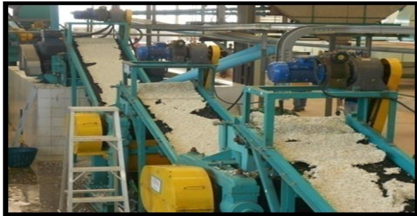
ภาพที่ 12 เครื่องรีดยางก้อนถ้วย (Creper)
