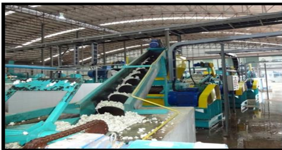
ภาพที่ 11 เครื่องย่อยยางก้อนถ้วย (Intermediate Shredder) ที่มา: จากการสังเกตแบบมีส่วนร่วม
