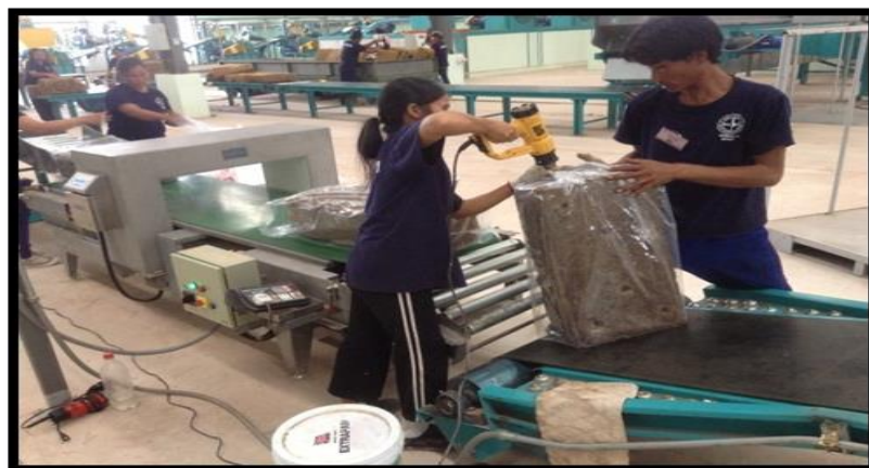
ภาพที่ 17 เครื่องสแกนโลหะและบรรจุหีบห่อ ที่มา: จากการสังเกตแบบมีส่วนร่วม
