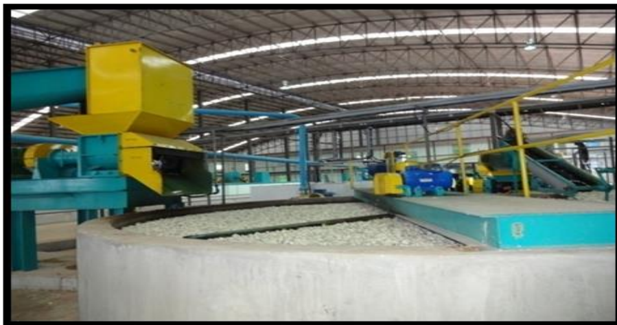
ภาพที่ 10 เครื่องตัดแบบใบคู่ Twin Screw Pre-breaker สำหรับตัด-สับยางก้อนถ้วย ที่มา: จากการสังเกตแบบมีส่วนร่วม
