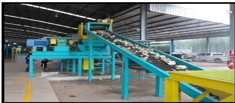
ภาพที่ 8 เครื่องลำเลียงยางก้อนถ้วย (Slab Cutter) ลงบ่อล้างที่ 1 ที่มา: จากการสังเกตแบบมีส่วนร่วม
