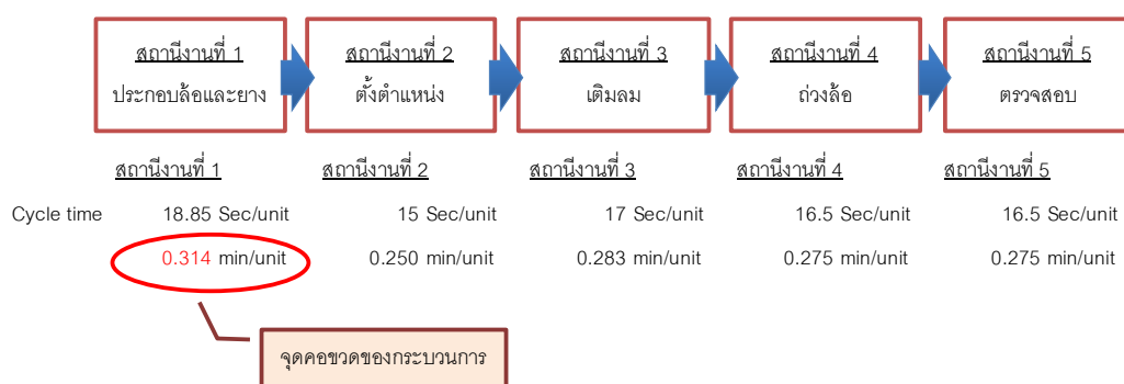
ภาพที่ 8 จุดคอขวดของกระบวนการประกอบล้อและยางรถยนต์ ที่มา: ฝ่ายการผลิต บริษัท เอเอฟ จำกัด (2557)
