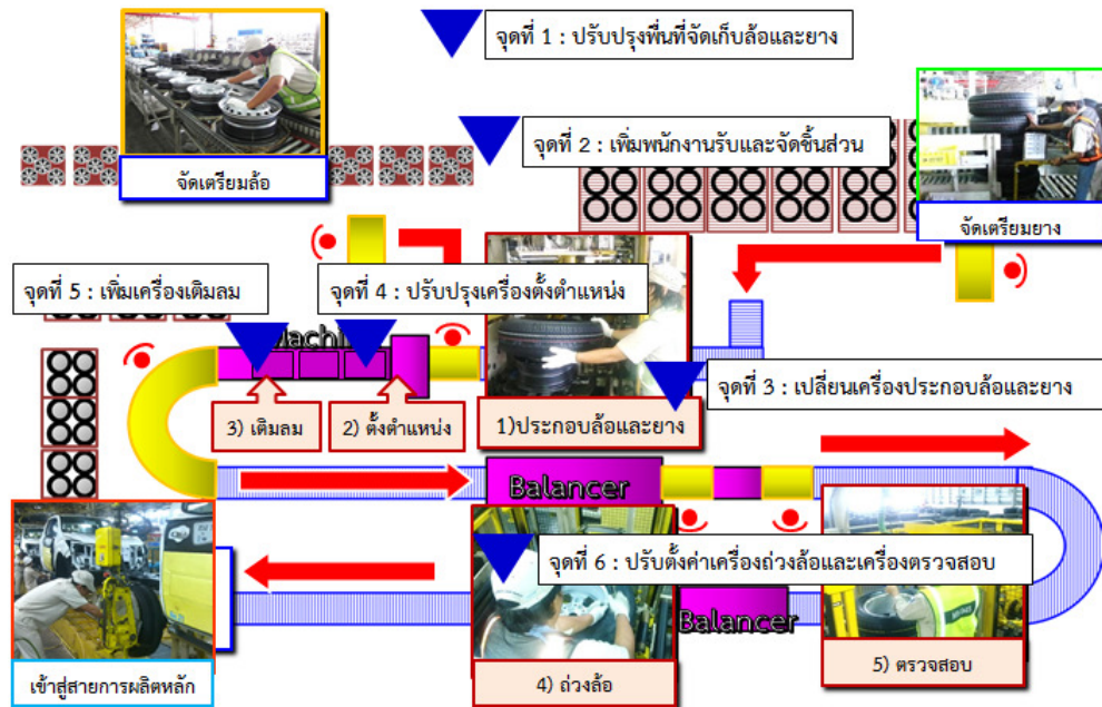
ภาพที่ 13 จุดปรับปรุงสายการผลิตสำหรับล้อและยางรถยนต์ขนาด 18 และ 20 นิ้ว ที่มา: บริษัท เอเอฟ จำกัด (2557)
